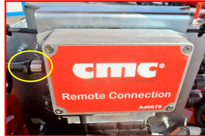
Afbeelding 73: kastje voor verbinding op afstand.
