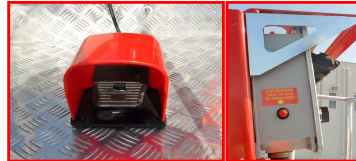
Afbeelding 10: “dodemanspedaal” en linkerkant van het kastje in de korf.
