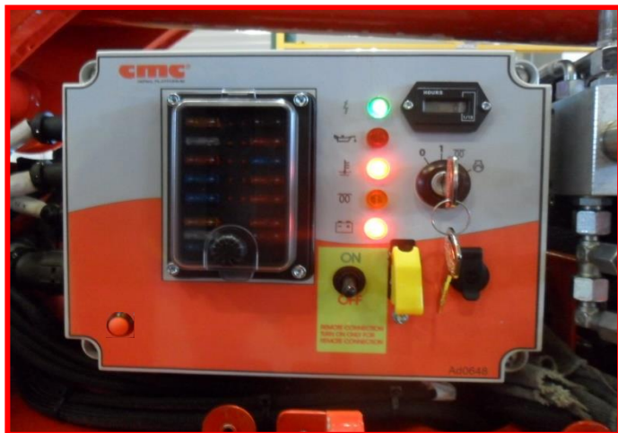
Afbeelding 6: bedieningspost met sleutel voor start verbrandingsmotor met afstandsbediening of console in de korf.
