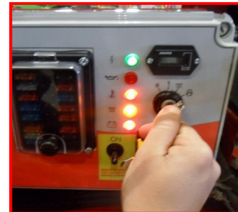
Afbeelding 5: fase voor verwarming bougies motor.
