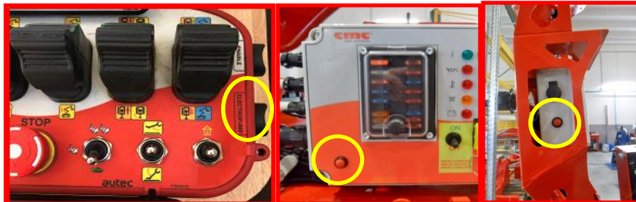
Afbeelding 62: activering elektrische pomp (*optioneel).
