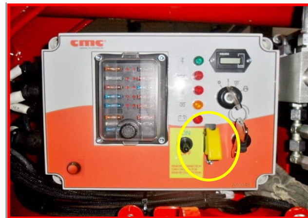
Afbeelding 52: toets bypass noodstop.
