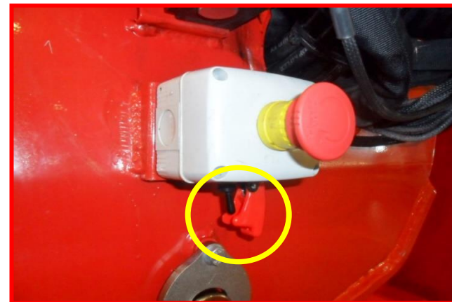
Afbeelding 45: toets voor bypass verplaatsingsblokkering.
