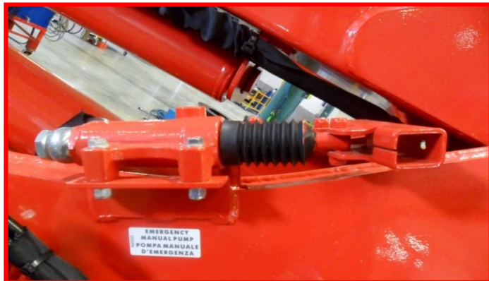
Afbeelding 60: inbrengpunt van de handpomp.
