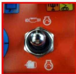
Afbeelding 7: hendel start/stop verbrandingsmotor/elektrische Motor op de afstandsbediening.
