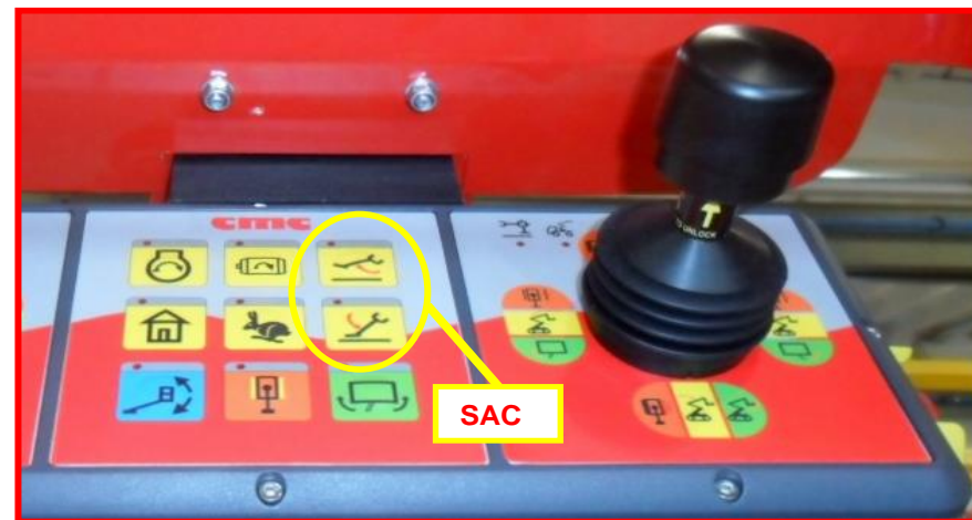
Afbeelding 49: knoppen automatische stabilisatie/destabilisatie bedieningspost in de korf.
