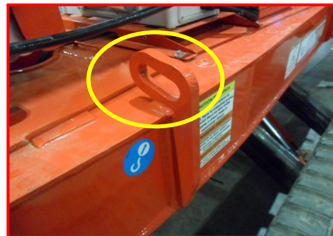
Afbeelding 41: bevestigingspunten op het onderstel.
