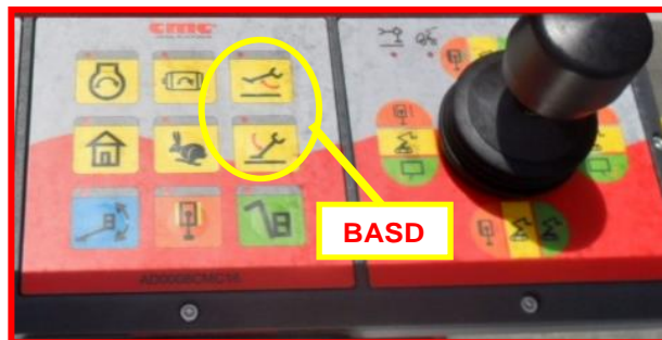
Afbeelding 27: knoppen automatische stabilisatie/destabilisatie bedieningspost in de korf.
