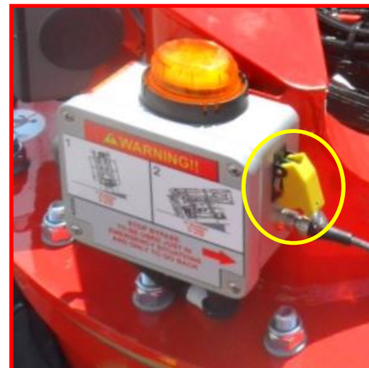
Afbeelding 24: toets voor bypass verplaatsingsblokkering.
