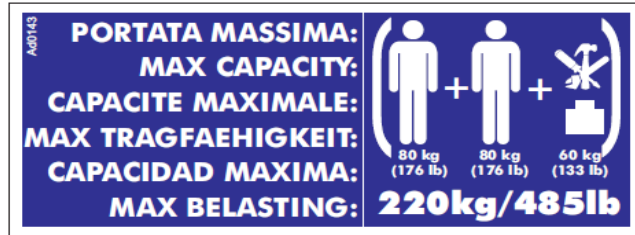
Afbeelding 52: maximaal toelaatbare belasting korf.
