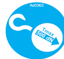
Afbeelding 73: aanduiding bevestigingspunten voor brugkraan.
