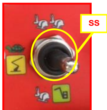
Afbeelding 22: keuzeschakelaar snelheid op afstandsbediening.
