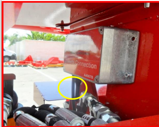
Afbeelding 95: kastje voor verbinding op afstand.
