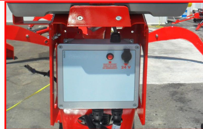
Afbeelding 9: bedieningspost platform in de korf.
