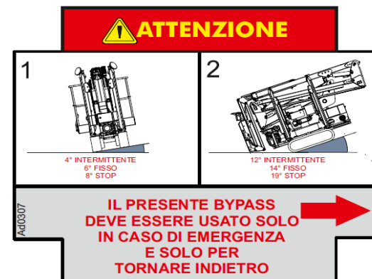
Afbeelding 48: kastje bypass verplaatsingsblokkering.
