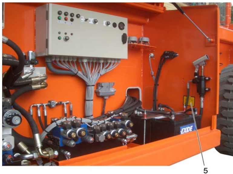
Ventielen- en elektracompartiment
