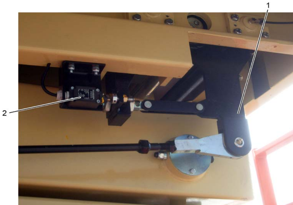
Een van de overlastbeveiligingshefbomen met schakelaar
