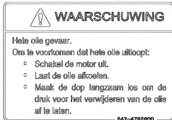
(5) Waarschuwing m.b.t. hydraulische olie (542-4782600)
