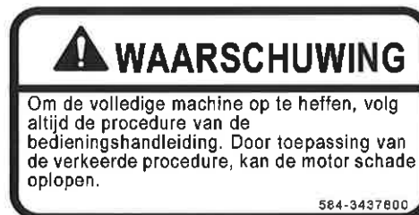
(23) Waarschuwing m.b.t. posities ophijzen van de machineconstructie (584-3437800)
