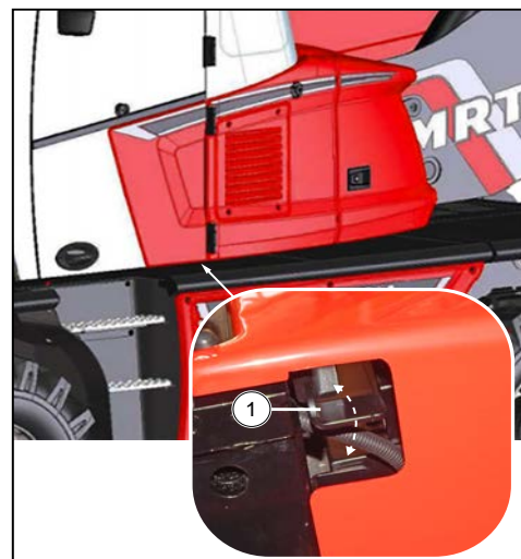
Afbeelding 61: Ontgrendelhendel voor deurruit buiten de cabine
