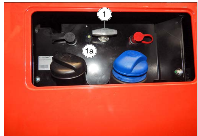
Afbeelding 66: Schakelaar voor ont koppeling van de accu
