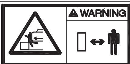
39 WAARSCHUWING! Gevaar voor beknelling. Werkbereik van de graafmachine niet betreden.
