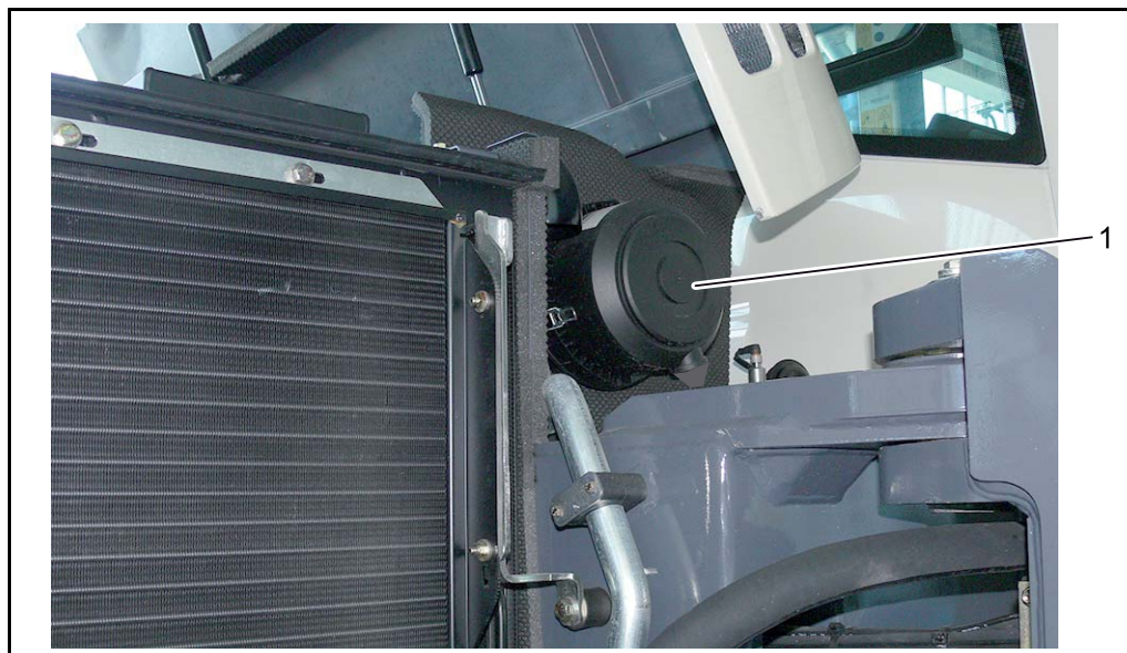
Afb. 6-9 Onderhoud van de luchtfilter
