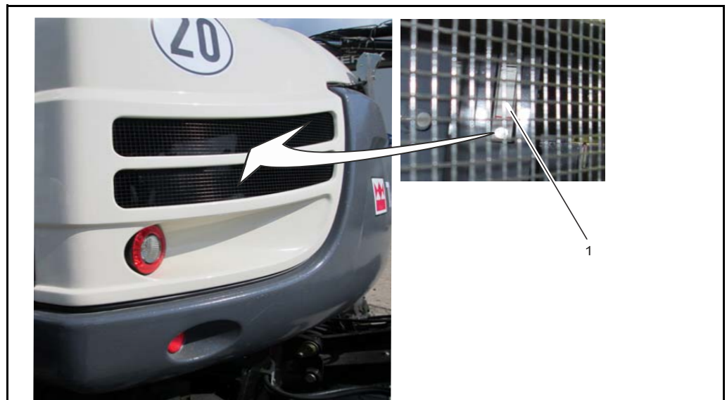
Afb. 6-25 Tank voor hydraulische olie - peilvenster
