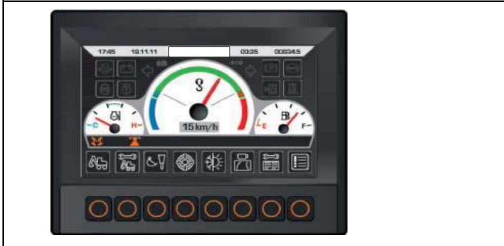
Afb. 5-42 Scherm bij geactiveerde waarschuwing voor overbelasting
